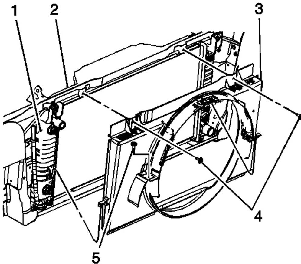
**Fig. 90: Identifying Fan Shroud**
