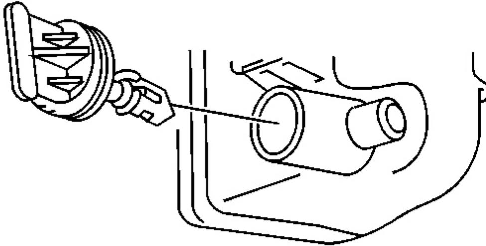
**Fig. 87: Radiator Drain Cock**
