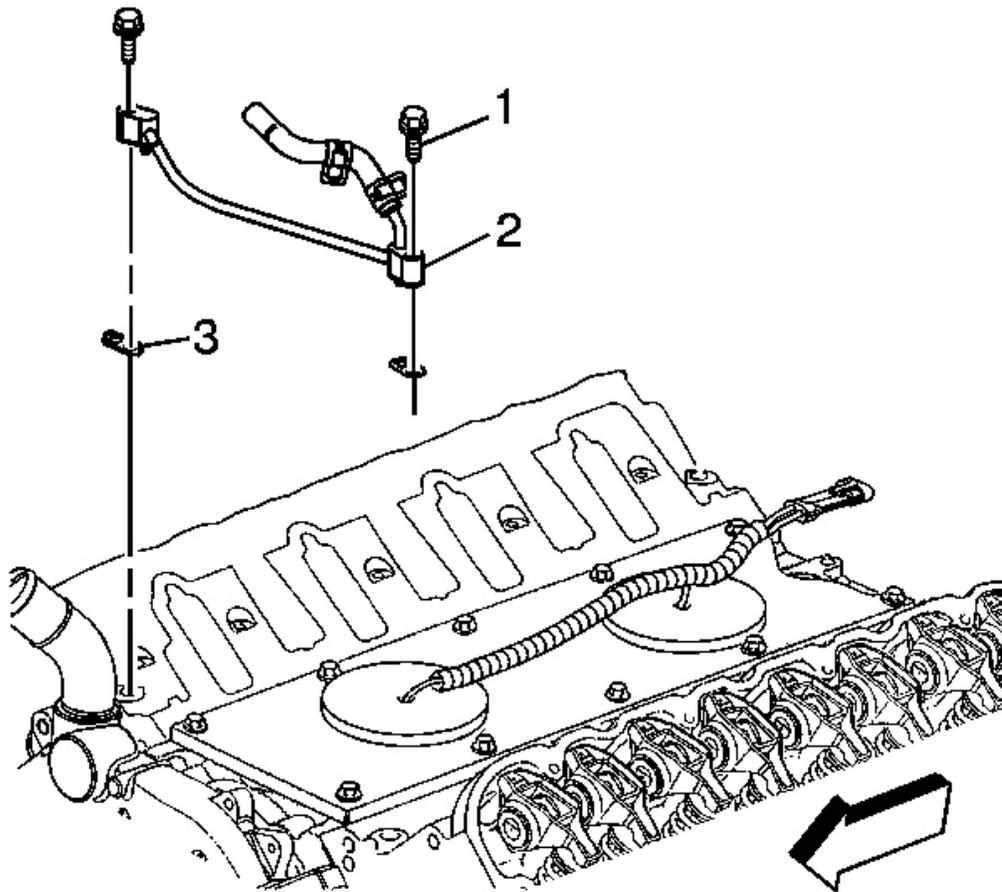
**Fig. 67: Coolant Air Bleed Pipe & Gaskets**
