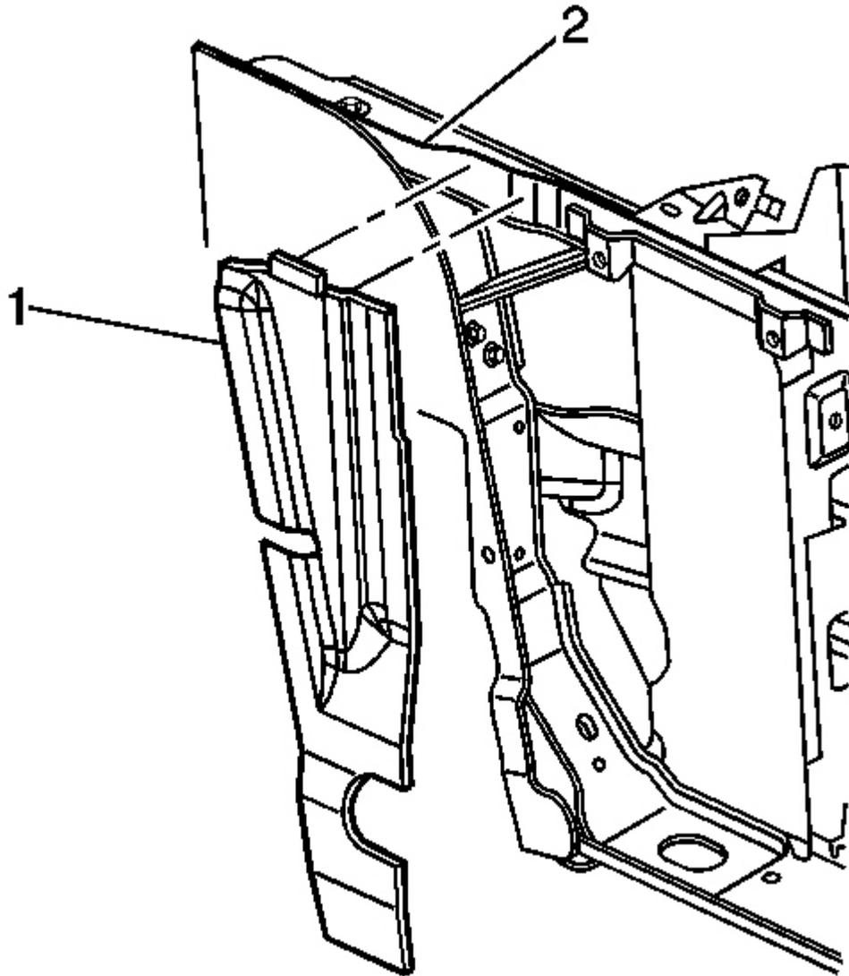
**Fig. 102: Radiator Air Baffles**
