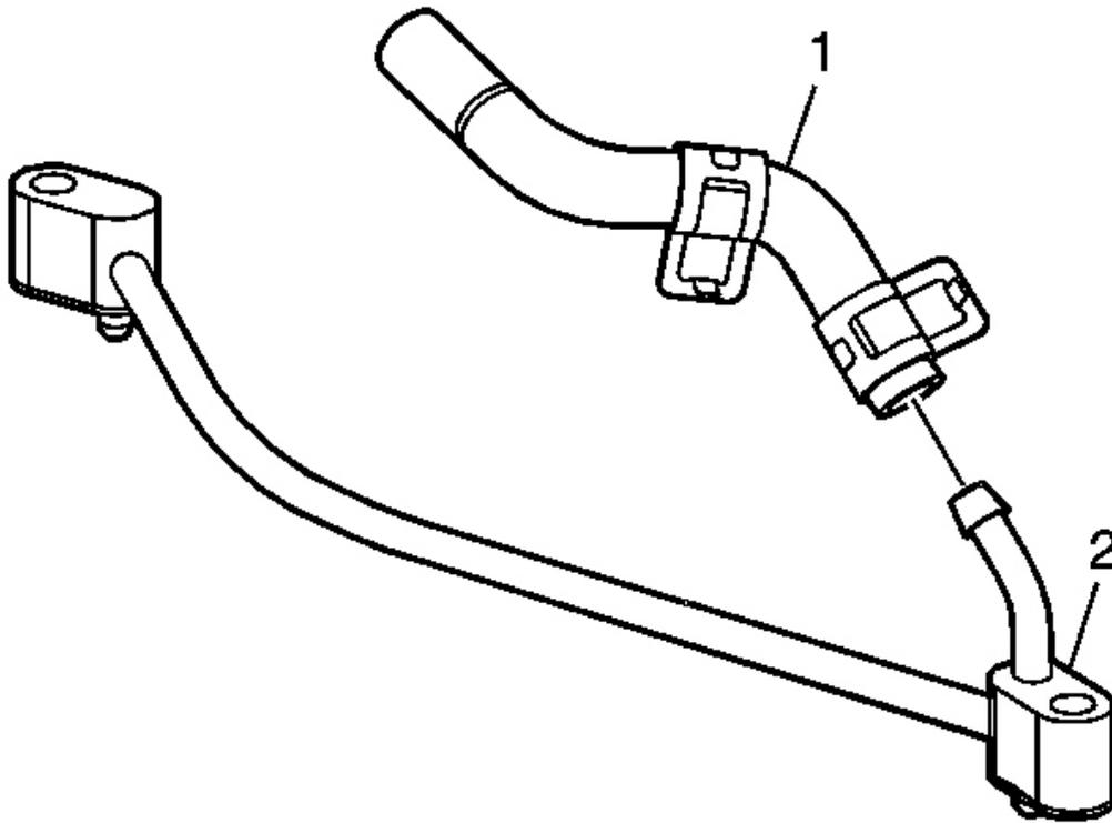
**Fig. 65: Coolant Air Bleed Hose & Pipe**
