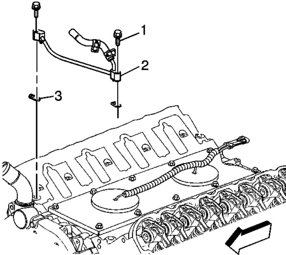
**Fig. 62: Coolant Air Bleed Pipe & Gaskets**
